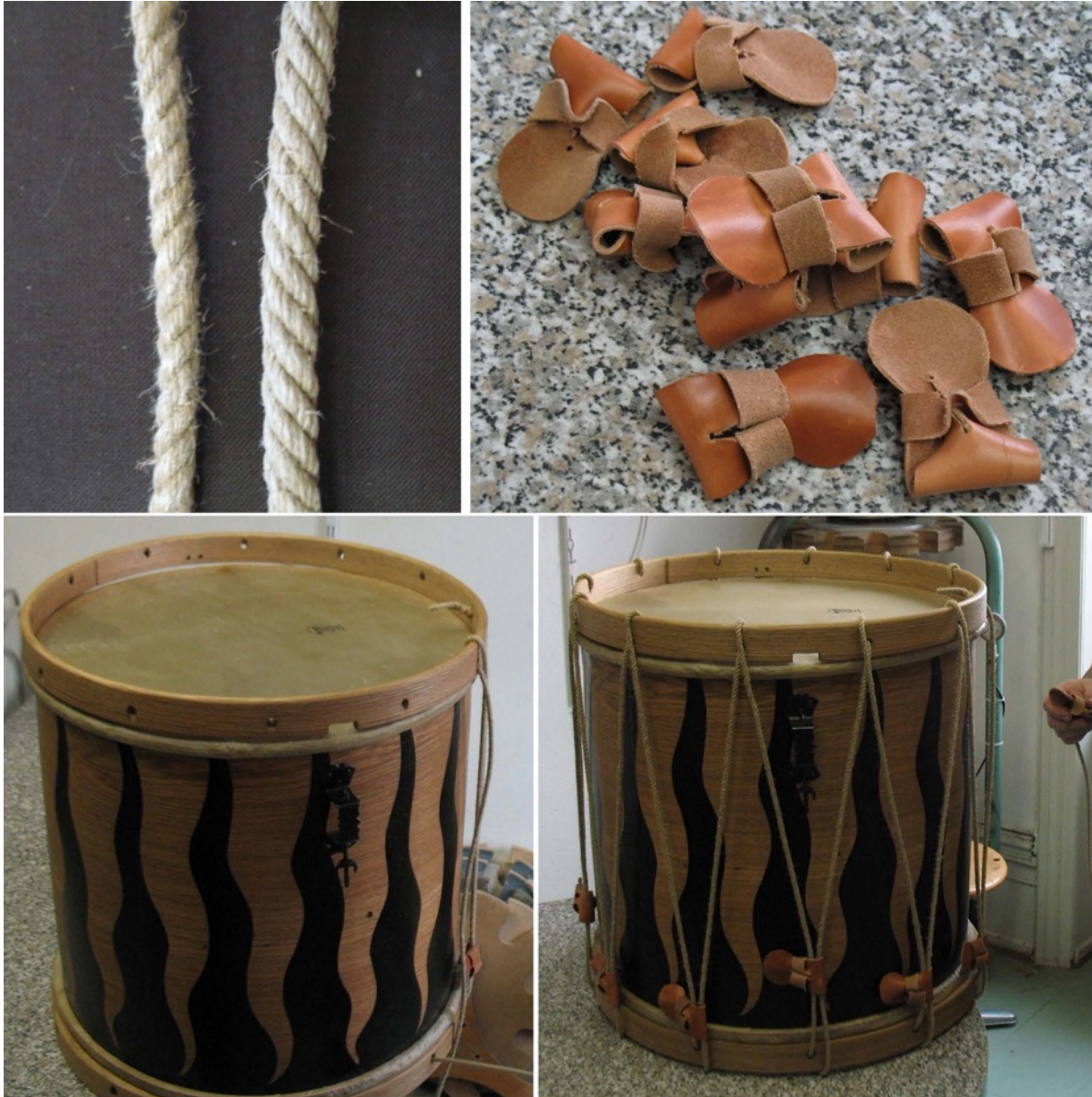
Abb. 46–49: Seile, Struppen, Bespannen der Trommel. Fotos: T. Hirsch.
