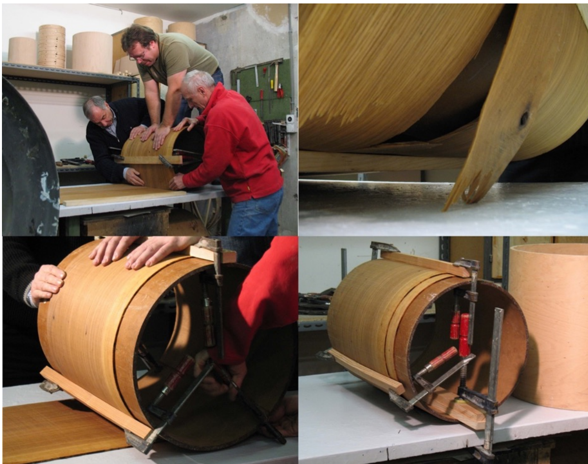
Abb. 29–32: Biegen der Trommelzargen durch W. Büchler und Mitarbeiter. Fotos: T. Hirsch.
