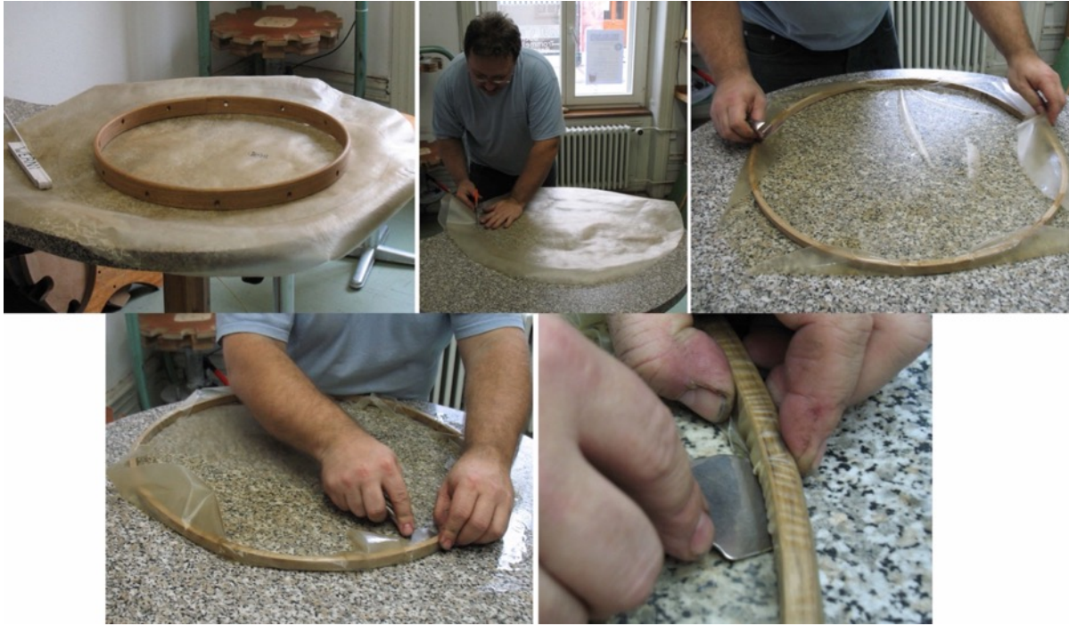
Abb. 41–45: Zuschneiden und Aufziehen der Trommelfelle. Fotos: T. Hirsch.
